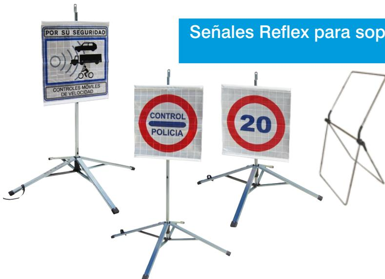
Señales Reflex para Soporte Telescópico, realizadas sobre lámina reflectante, unida mediante soldadura de alta frecuencia a un soporte de Ioneta de PVC. La lámina es microprismática y resistente a la intemperie y a los rayos U.V. Sobre la lámina reflectante se serigrafía cualquier texto, o señal del código de circulación.
