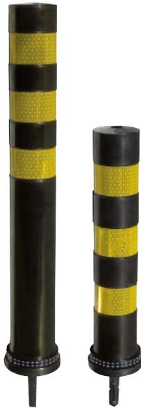
Pilonas flexibles modelo CITY fabricadas en TPU. Permite su completa deformación y recupera inmediatamente su posición inicial. Anclaje mediante taco químico epoxi o similar. Incorpora 3 bandas reflectantes REFLEXITE ámbar o blanco. Se comercializa en 2 alturas.
