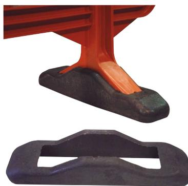
La valla MOVIT® dispone en opción de un pie de caucho reciclado, de 4 Kg de peso, con el que se incrementa el del conjunto hasta 21 Kg. De fácil incorporación, ofrece una gran mejora frente a vientos fuertes a la vez que protege la estructura plástica de los pies de la barrera, incrementando la vida de la misma.
