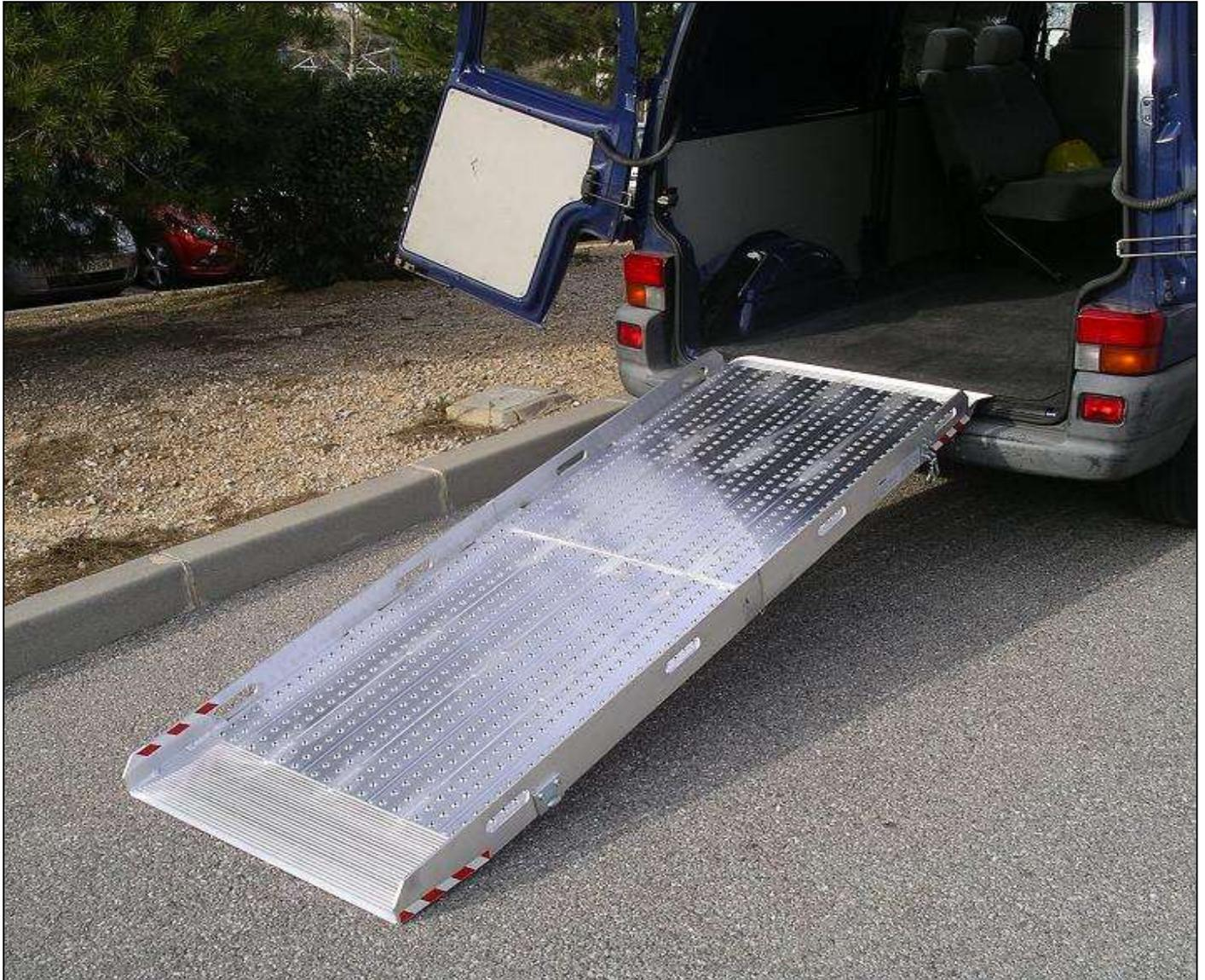
Rampa AOH-F 800, plegable, Longitud 2500 mm, Anchura 800 mm, con borde de 80 mm y asas incrustadas en el perfil del borde.
