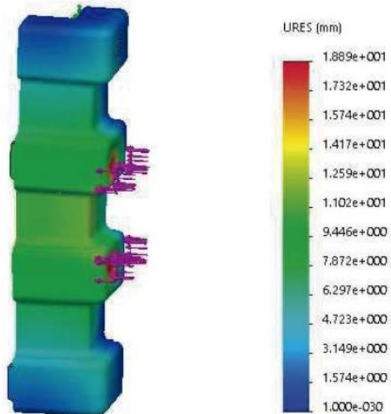
En esta imagen podemos ver la deformación consecuente de la aplicación de la carga de 5000 N, en el punto más crítico llega a 19 mm.
