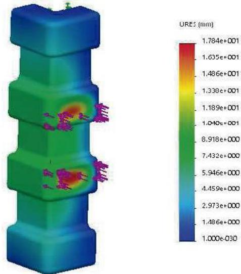
En esta imagen podemos ver la deformación consecuente de la aplicación de la carga de 5000 N, en el punto más crítico llega a 18 mm.
