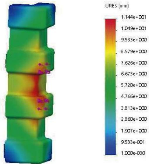
En esta imagen podemos ver la deformación consecuente de la aplicación de la carga de 5000 N, en el punto más crítico llega a 14 mm.
