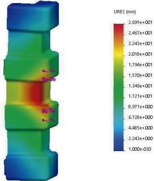
En esta imagen podemos ver la deformación consecuente de la aplicación de la carga de 5000 N, en el punto más crítico llega a 27 mm.
